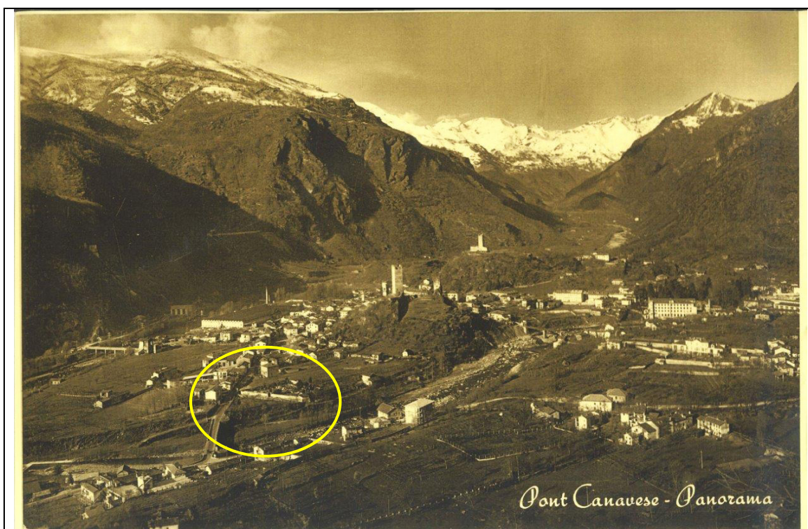
Foto n.2 – Immagine dell'area oggetto di intervento verso il 1940 . Se confrontata con la foto n.1 , si può osservare la posizione originaria della scarpata che separava i depositi fluvioglaciali dai depositi alluvionali recenti . L'antico perimetro cimiteriale incideva ad angolo retto con Via Roma , interessando parzialmente il settore di prevista edificazione .
