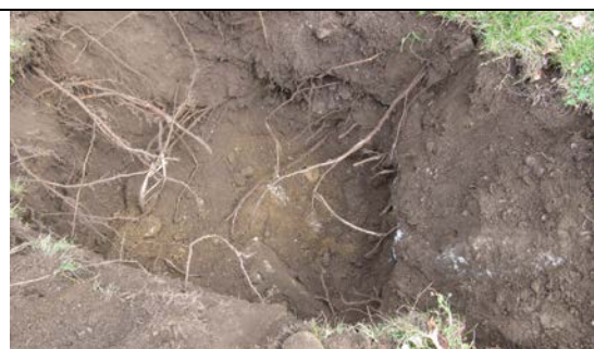
Foto n.5 - la stratigrafia è riconducibile ad un primo livello di suolo limoso sabbioso di colore marrone scuro con resti radicalari , passante alla base a materiali di riporto ghiaiosi in matrice di limo sabbioso di colore tendente al giallo-ocra .
