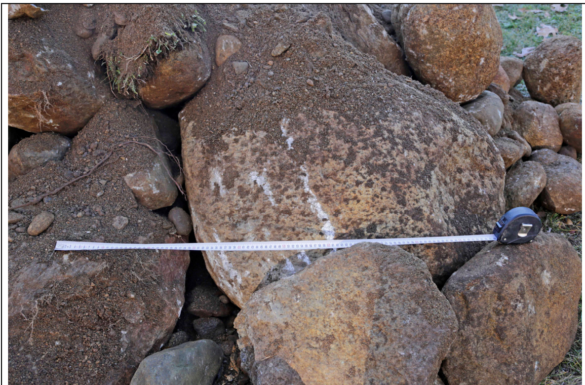
Foto n.3 – Pozzetto SE . Trovante con diametro di circa 1 m
