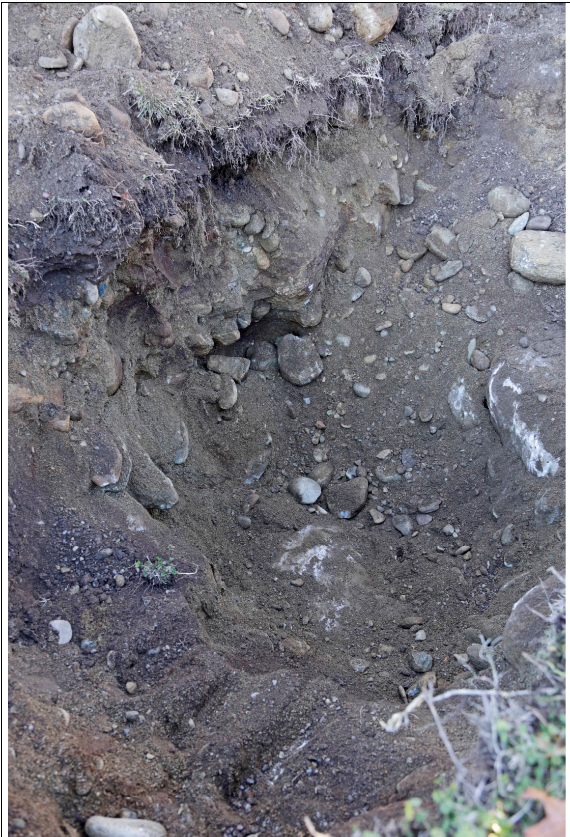
Foto n.1 – Pozzetto SE . Si osservino sul fondo i trovanti che impediscono la prosecuzione dell'escavazione
